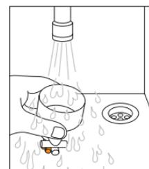
Den Bajonettverschluss der Mischerschale (oranger Hebel) nach links drehen. Die Mischerschale lässt sich nun nach vorne abziehen und nachdem der Schlauch aus der Auslaufhalterung gedrückt wurde, aus
