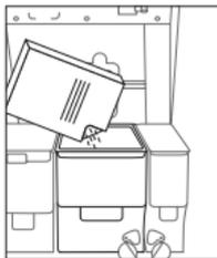
Den Deckel der Instantproduktbehälter öffnen und Produkte nach Etikettierung einfüllen.
