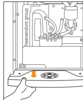
Entnehmen und entleeren Sie die Tropfschale, reinigen Sie das Tropfgitter von innen und außen.
