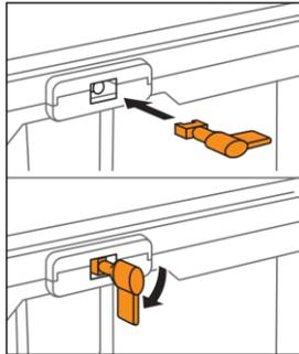
Stecken Sie den Türkontaktschlüssel, der sich im Gerätedeckel befindet, in das Gerät ein. Durch eine 90° Drehung nach unten, schaltet sich das Gerät ein. Warten Sie bis das Gerät betriebsbereit ist.
