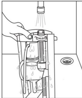
Den Brühler mit warmem Wasser und Reiniger spülen. Trocknen Sie danach den Brühler vor dem Einsetzen gut ab.
