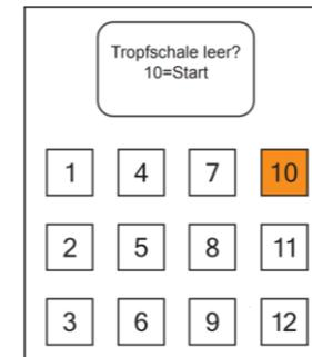
Auch bei diesem Reinigungsvorgang erscheinen die Aufforderung die Tropfschale und die Wasserzufuhr zu überprüfen. Führen Sie diese Arbeitsschritte wie in der Schnell-Reinigungsanleitung beschrieben, durch.
