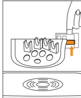
Die Auslaufhalterung entnehmen Sie, indem Sie rechts den mittleren Kunststoff-Steg von hinten aus der Metallhalterung drücken.
