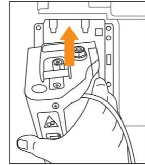
Neigen Sie den Variflex Brühler leicht zu Ihnen und heben Sie den Variflex Brühler leicht an, so lässt sich dieser aus der Motorhalterung heben.
