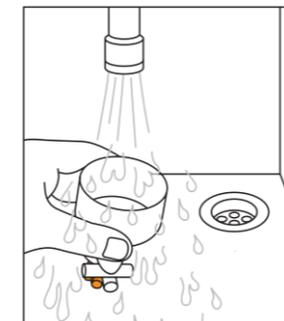
Entnehmen Sie den Dampfdeckel von der Mischschale. Warmes Wasser und Reiniger lösen die Produktrückstände zuverlässig. Keine rauen Reinigungsschwämme verwenden, da sich sonst an den angerauten Stellen einfacher Produktreste verfangen und die Maschine schneller verstopft.
