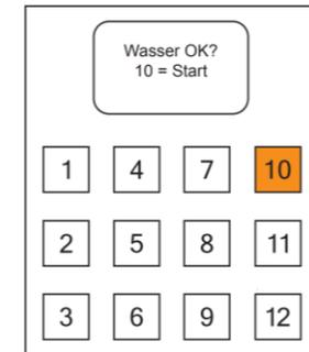
Nach der Bestätigung der entleerten Tropfschale werden Sie aufgefordert die Wasserversorgung sicherzustellen. Füllen Sie bei Bedarf den Wassertank nach und bestätigen Sie auch dies durch drücken der Taste 10.
