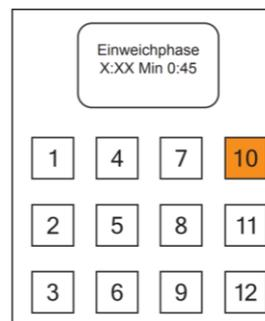
Nachdem die Einweichphase abgeschlossen ist, werden Sie aufgefordert die Reinigungstabs (Artikelnr.:12/085) in den Brüher zu geben. Nachdem Sie dies getan haben, bestätigen Sie es mit der Taste 10.
