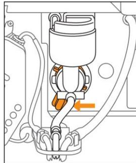
Den Bajonettverschluss der Mischschale (oranjer Hebel) nach links drehen.
