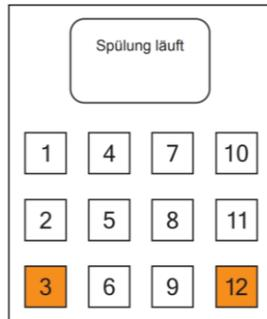
Durch drücken der Taste 3 und Taste 12 der Wahltastratur öffnet sich das Schnellreinigungsprogramm
