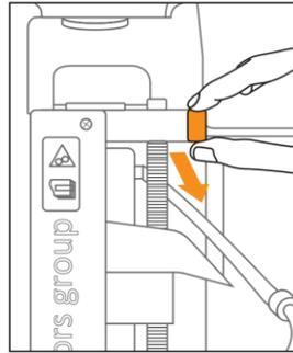
Indem Sie den orangenen Entsperrhebel nach vorne ziehen, entriegeln Sie den Variflex Brühler.
