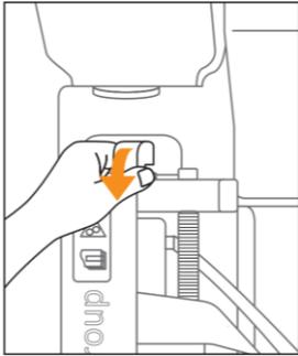
Für eine einfachere Entnahme des Variflex Brühers, ziehen Sie den Trichter des Mahlwerks ab.
