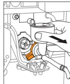
Die Mischschale lässt sich nun nach vorne abziehen und nachdem der Schlauch aus der Auslaufhalterung gedrückt wurde, aus der Maschine entnehmen.
