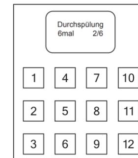
Danach wird der Brüher sechs Mal gespült. Schalten Sie danach das Gerät aus und schließen Sie die Tür.
