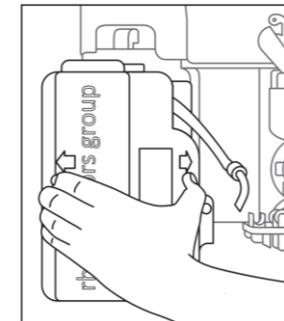
Bringen Sie nun die Abdeckung des Variflex Brühers wieder an. Führen Sie den Schlauch durch die dafür vorgesehene Öffnung und stecken den schwarzen Auslaufwinkel in die Auslaufhalterung.
