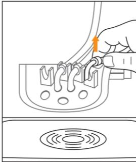
Öffnen Sie die Tür und entnehmen Sie die Auslaufschläuche aus der Auslaufhalterung, indem Sie diese nach oben abziehen.
