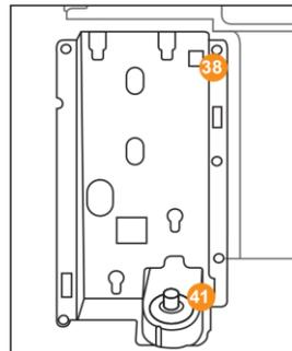
Für den Finbau setzen Sie den Brühler auf den Antrieb **41** auf. Drücken Sie den Brühler nach unten und den oberen Teil des Brühers nach innen, dass der Entsperrhebel **38** einrastet.
