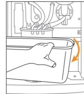
Entnehmen, entleeren und reinigen Sie den Kaffeesatzbehälter. Reinigen Sie den Geräteboden innen und setzen Sie die entnommenen Teile in umgekehrter Reihenfolge wieder ein.
